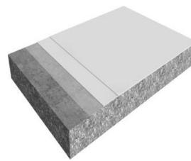
Изграждане на системата: Sikalastic®-612 нанесен на 1 или 2 слоя
