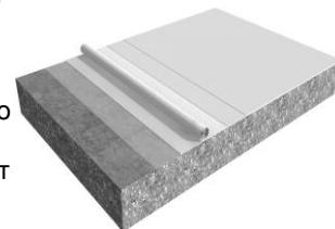
Изграждане на системата: Sikalastic®-612 нанесен в един слой, армирован със Sikalastic® Fleece-120 и запечатан със Sikalastic®-612
